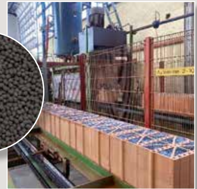
Die Ziegel nach der Verfüllung
